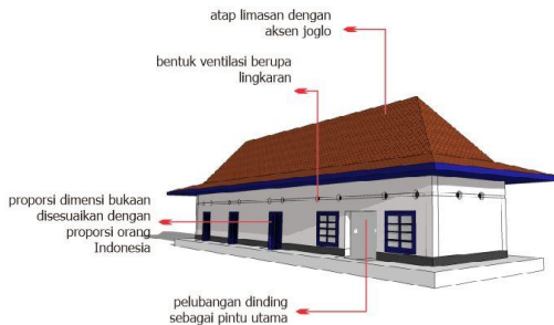
Gambar 10. Kemiripan Gaya Bangunan Stasiun Palbapang (Sumber : Penulis)
