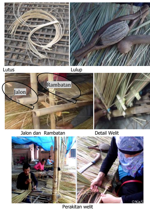
Gambar 6. Proses Perakitan Welit (Sumber: Dokumentasi Pribadi, 2012)
