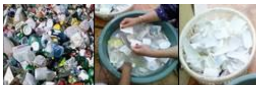
Gambar 1. Sampah plastik melalui proses pencucian dan pengeringan
