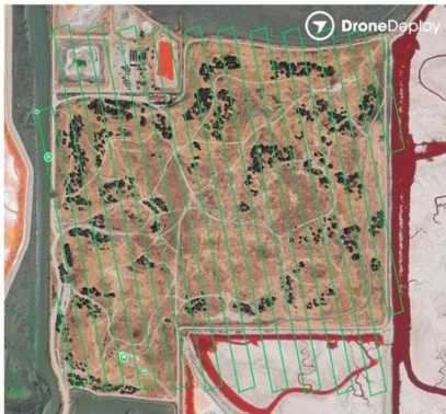
Gambar 3. Menentukan waypoint pada software dronedeploy .
