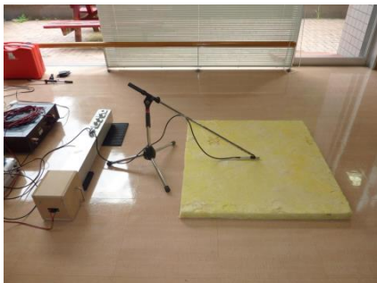
Gambar 2. Kondisi pengukuran material dan kalibrasi sensor yang dilakukan dekat material
