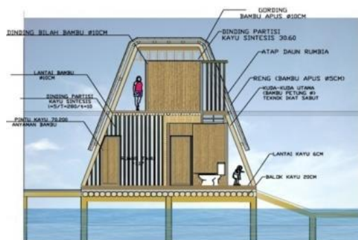
Gambar 13. Potongan depan bangunan. Sumber: pribadi(2014 )
