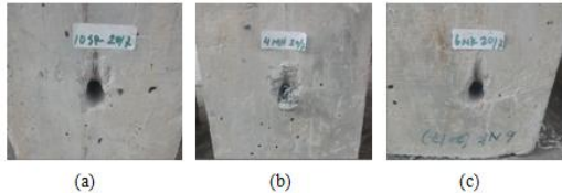
Gambar 13. Kerusakan pada beton , f'_c 21,27 MPa, Kayu:(a)Surian,(b)Mahoni,dan(c)Nangka
