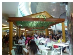
Gambar 6. Sinar matahari yang masuk diberi kisi-kisi agar tidak langsung mengenai pengunjung
